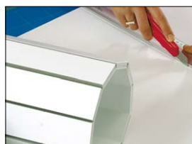
Biegen: kartonkaschierte Platte rückseitig keilförmig einschneiden
