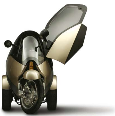
“CLEVER” – Stadtfahrzeug für 2 Personen in Tandem-Sitzanordnung, Aluminiumleichtbaukonstruktion mit GFK-Kunststoffverkleidung, Hersteller: BMW, Design: Peter Naumann
