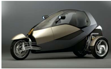
“CLEVER” – Stadtfahrzeug für 2 Personen in Tandem-Sitzanordnung, Aluminium-leichtbaukonstruktion mit GFK-Kunststoffverkleidung, Hersteller: BMW, Design: Peter Naumann
