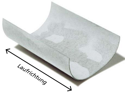
Das angefeuchtete Papier wellt sich quer zur Laufrichtung.
