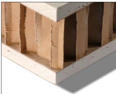
Sandwichplatte Kern: Pappwaben, Decklagen: Gipskarton
